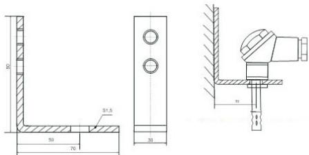
Новый датчик имеет **большой набор конструктивных исполнений**: для крепления к стене при помощи углового кронштейна, для простой установки на воздуховод при помощи фланца, для крепления в бобышке при помощи встроенного подвижного штуцера.
