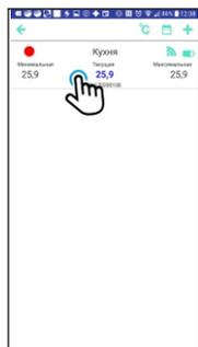
На странице измерений в верхней части экрана отображаются имя термометра, цвет маркера, кнопка выбора единиц измерения, уровни Bluetooth сигнала и заряда батареи.
